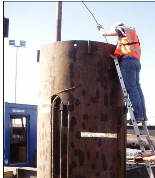
De SAAF wordt neergelaten in de meetbuis
