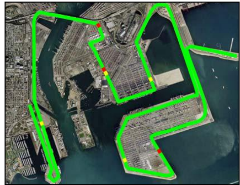
Web-visualisatie van een DSS-systeem voor een pijpleidingtracé
