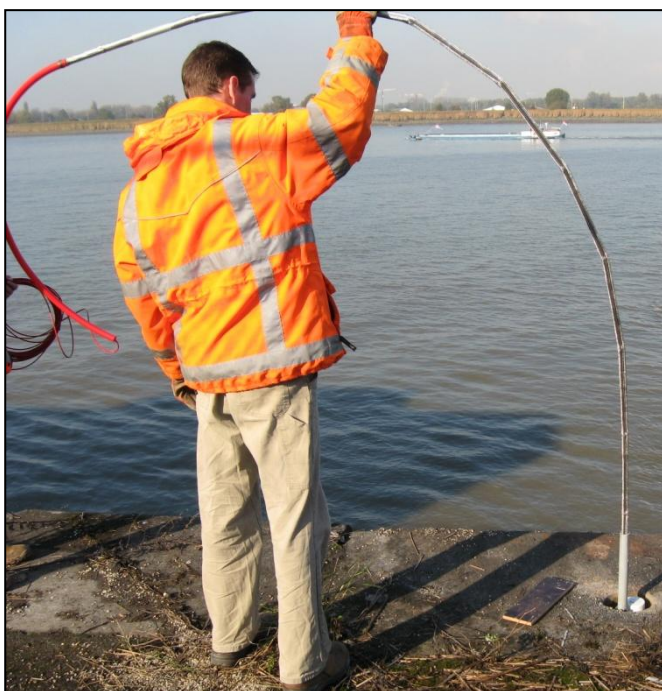
Installatie van een SAAF
